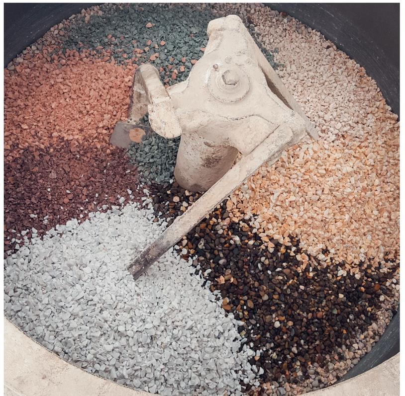
Kiesmischung für die Herstellung eines Putzes.
